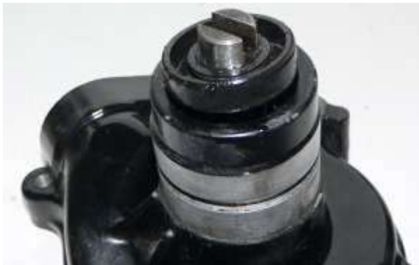
Ersetzen Sie den Wellendichtring. Vergewissern Sie sich, dass er vollständig sitzt. Verwenden Sie ein Dichtungsmittel, falls erforderlich/gewünscht.
